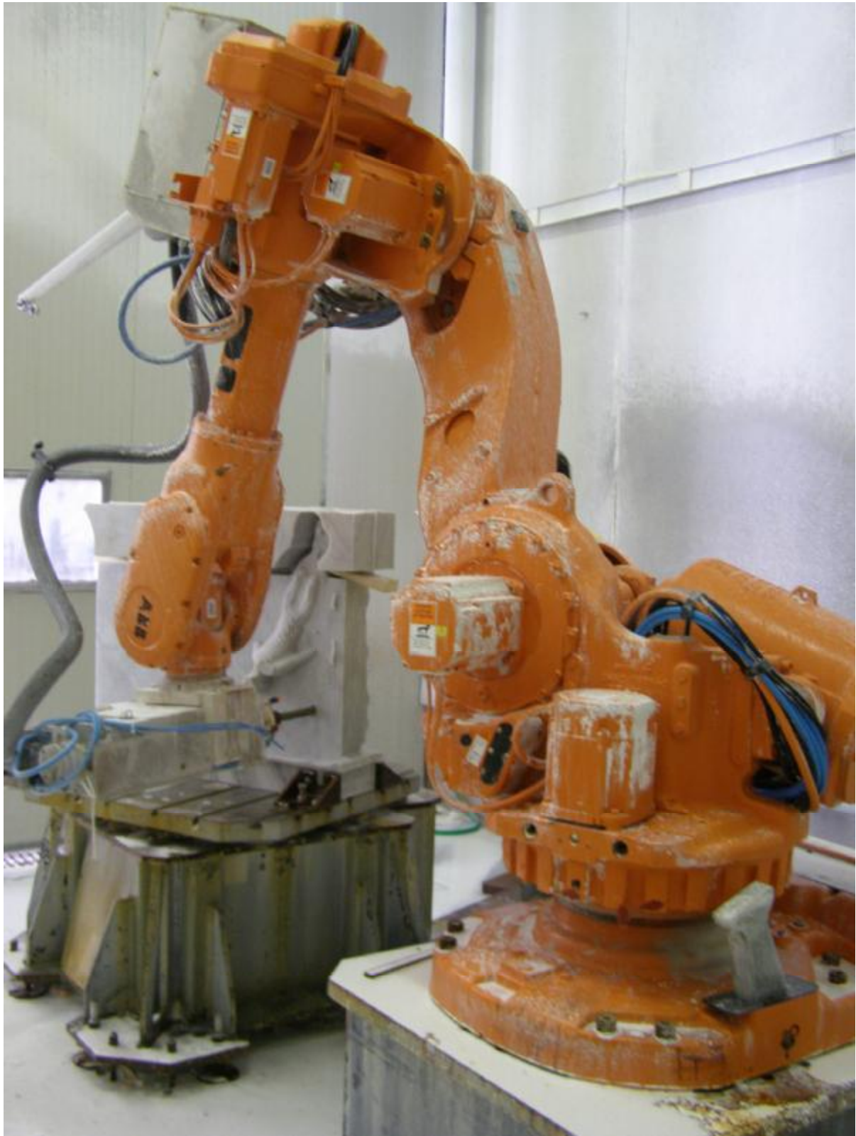
Příklad práce na robotizovaném pracovišti při obrábění reliéfu z carrarského mramoru.
