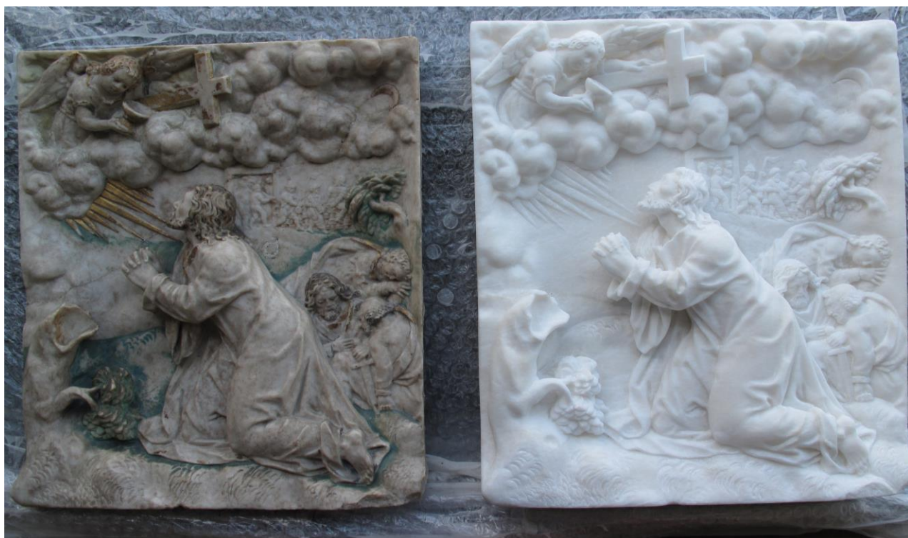
Reliéf po sochařském opracování a temperování (srovnání s originálem)
