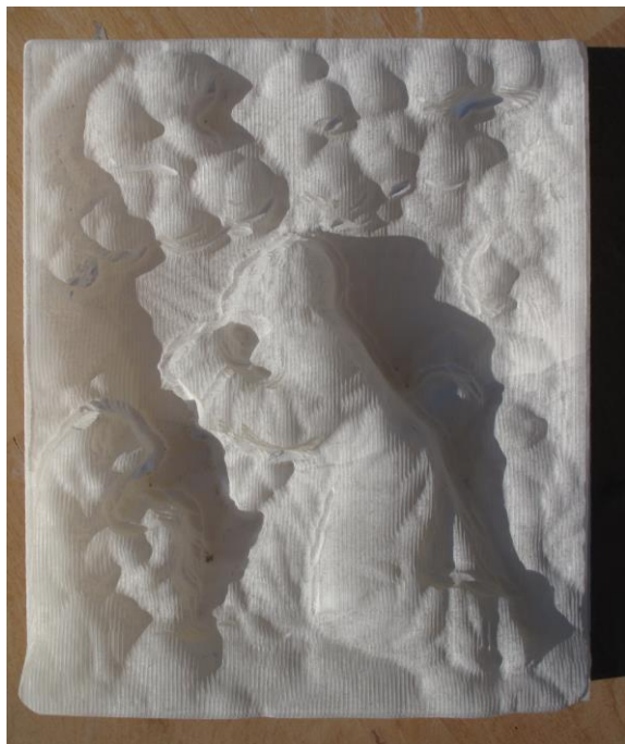
Reliéf po ohrubování robotem
