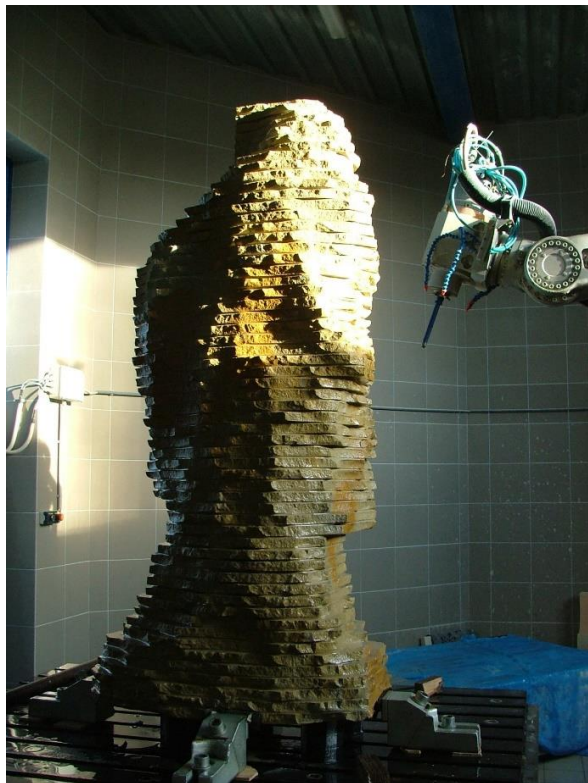
Obrázek 4 - Pohled na ořezaný polotovaru na otočném stole robota
